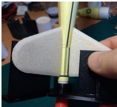
То же самое сделай с оставшимися двумя стабилизаторами и оставь всю конструкцию в сторонку, чтобы дать подсохнуть клею.
