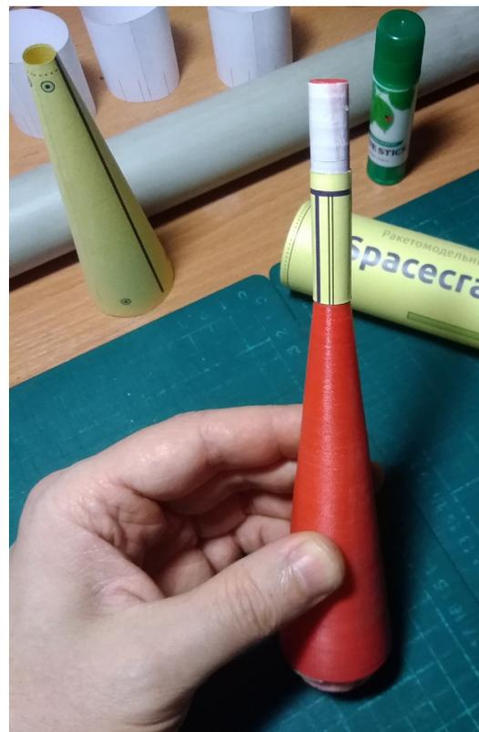
Чтобы конус всё-таки наделся и сел ровно на коническую часть болванки, нужно срезать 1 мм от края узкой части. Для этого сними моторный отсек с болванки и надень на неё конус, аккуратно прижимая лезвие канцелярского ножа отрезай узкое колечко шириной в 1 миллиметр.
