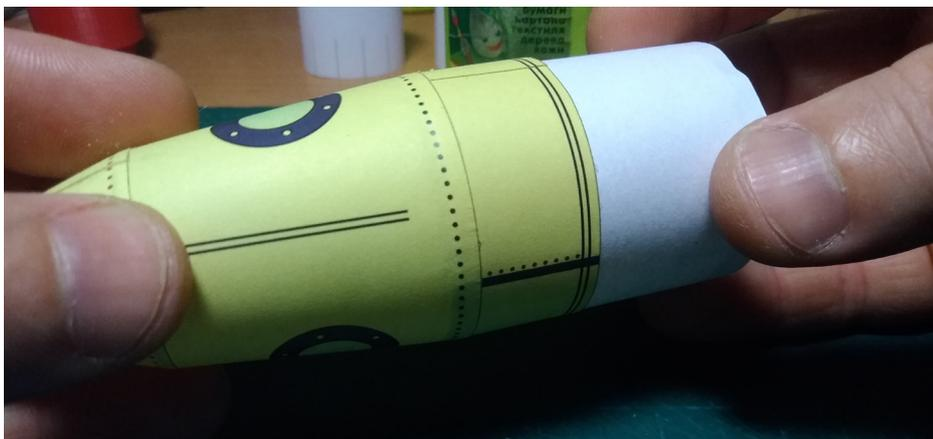
Болванка для головного обтекателя и трубка для корпуса больше не понадобятся, можешь убрать их в коробку. А вот болванка для хвостового конуса и моторного отсека нужны для ровной установки стабилизаторов.
