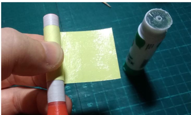
Готовую деталь моторного отсека можно снять с болванки, вращая в другую сторону, противоположную направлению намотки детали, и оставить для сушки.
