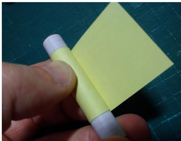
Теперь нанеси клей на оставшуюся поверхность заготовки и с натягом оберни эту часть до полной намотки. Обрати внимание на то, что моторный отсек должен быть прочным по всей внутренней поверхности! Его нельзя намазать клеем в начале и в конце, его нужно промазать по всей поверхности.
