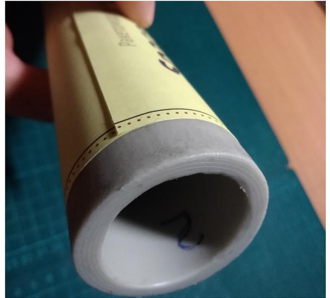
В итоге должна получиться бумажная трубка, плотно, без зазоров прилегающая к поверхности пластмассовой трубки. Но если ты заметил, не вся ширина шва могла приклеиться, это можно обнаружить, если провести остриём шпажки, аккуратно поддевая верхний край шва.
