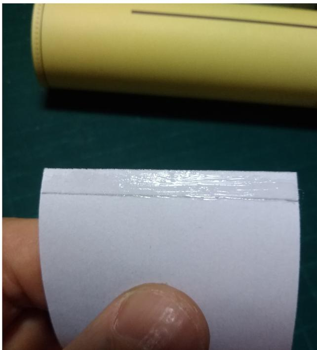
Нанеси клей-карандаш до этой линии и склей заготовку так, чтобы получилось кольцо. Пока клей окончательно не высох и не закрепил шов, нужно обязательно примерить, как кольцо входит в корпус.
