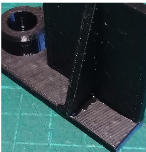
Важно проследить, чтобы площадки и подставка образовали угол  $90^\circ$ , без перекосов. Проконтролировать это можно используя линейку-треугольник. Суперклей из тюбика застывает не моментально, а в течение нескольких минут, этого времени хватит, чтобы поправить криво установившиеся детали.
