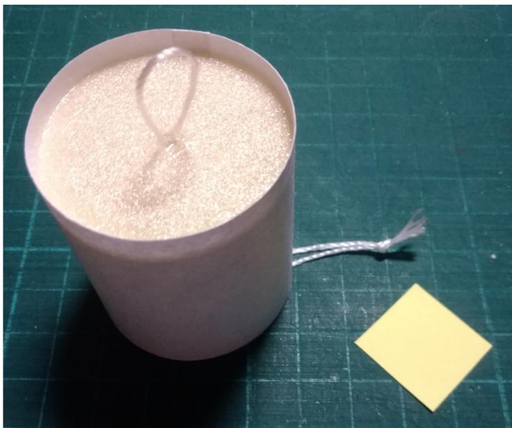
Сейчас отложи в сторону обработанные стабилизаторы и возьми юбку обтекателя, куда ты вклеил петлю из нитки. Думаю, клей уже немного зафиксировал петлю, чтобы она не выпала. Сейчас нам нужно вклеить узелок на нити внутрь юбки при помощи квадратного кусочка бумаги.
