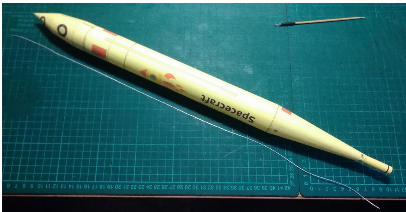
Нить крепления системы спасения имеет такую же длину, как общая длина модели ракеты, плюс небольшой запас. Можно вставить головной обтекатель в корпус и отрезать нить примерно той же длины. Длина эластичной нити уже задана, её разрезать не нужно.
