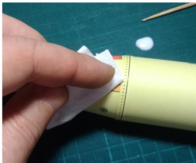
Выступающий лишний клей убери салфеткой. И оставшийся клей с рабочей поверхности стола тоже. Слегка прижми пальцами место склеивания, одновременно прокручивая, тем самым прижимая шов по всей окружности. Теперь нужно немного времени чтобы клей подсох, сразу снимать склеиваемые детали не нужно. Отставь болванку с деталями в сторону, чтобы клей высох.
