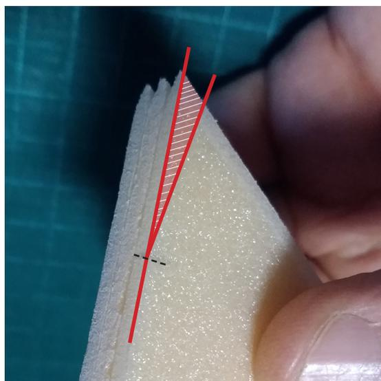
Как только зазор исчезнет, стачивать больше не нужно. Сейчас корневая хорда разделилась на две части, которые должны плотно прилегать к моторному отсеку и конической поверхности.
