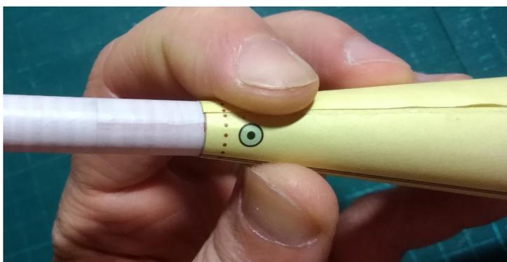
При склеивании этой детали важно следить, чтобы крайний срез бумажной заготовки со стороны цилиндрического хвостика конусной болванки был совмещён с местом перехода цилиндрической части в конусную, т.е. не заходил на хвостик и не уходил от границы перехода в сторону, иначе ширины получившегося шва не хватит для прочной склейки.
