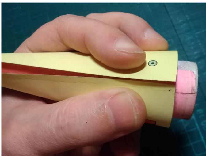
Склеивать их нужно точно так же, как и предыдущую деталь корпуса: смазать край клеем-карандашом до ограничительной линии, обернуть вокруг конусной части болванки выравнивая крайние срезы детали, завести клеевой шов под другой край, визуально наметить середину, плотно натянуть бумагу вокруг болванки и прижать середину пальцем.
