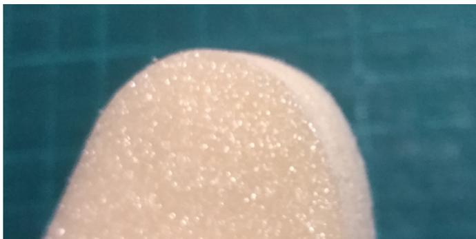
Верхнюю кромку стабилизаторов нужно скруглить, остальные кромки сделать ровными и плоскими.
