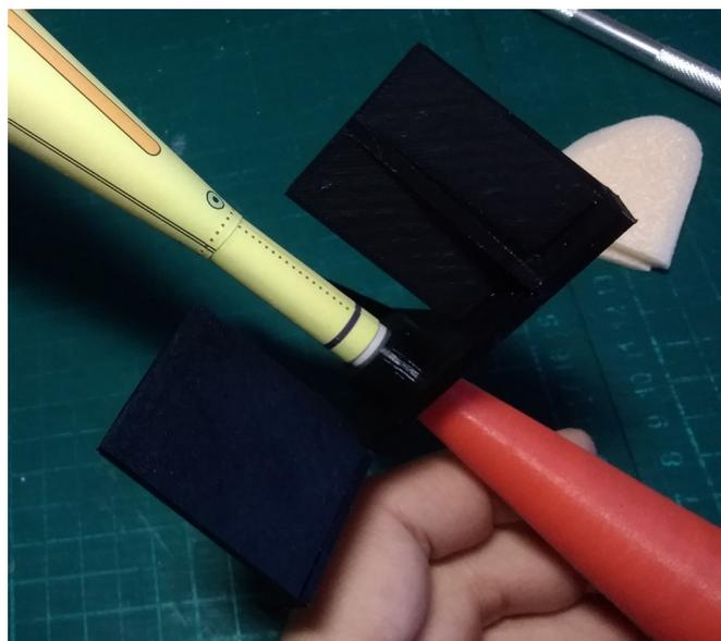
На торец корневой хорды нанеси немного полимерного клея, приложи стабилизатор плоскостью к вертикальной площадке и совмести его торец с корпусом так, чтобы нижний край стабилизатора выровнялся с линией на моторном отсеке.
