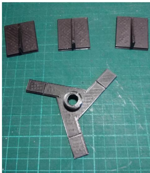
Но прежде нужно собрать и склеить ещё одно вспомогательное приспособление: на трёхлучевую подставку с отверстием посередине нужно приклеить три плоских площадки, вертикально вставив их пазы в соответствующие выемки на трёхлучевой подставке.
